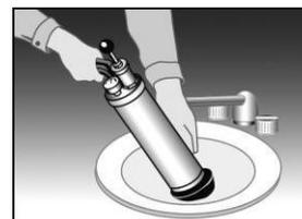
4. Во избежание разбрызгивания следует **твердо надавить** на инструмент, прикладывая свой вес к его задней части инструмента. Затем быстро спустить курок для создания эффекта «падающего молота».
