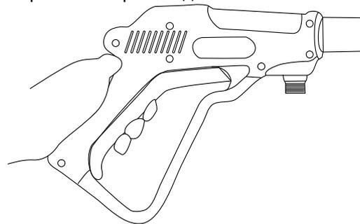
**ВНИМАНИЕ!** Мойка высокого давления оборудована выключателем с автоматическим включением и выключением. Мойка работает только при нахождении выключателя питания в положении «включено». При прекращении работы пистолета для распыления воды двигатель останавливается автоматически.
