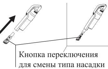
Для смены ворсовой части насадки на узкую и наоборот, нажмите на кнопку переключения на насадке. Тяните за ворсовую насадку в наружную или внутреннюю сторону, в зависимости от того, какая насадка вам нужна.
