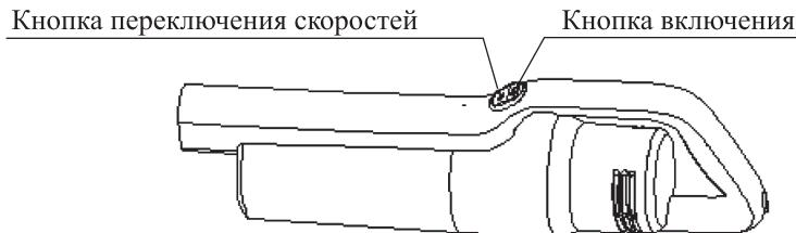
Нажатие на кнопку включения включает пылесос на низкой скорости. Для переключения скоростей пользуйтесь специальной кнопкой. Для выключения пылесоса снова нажмите на кнопку включения.
