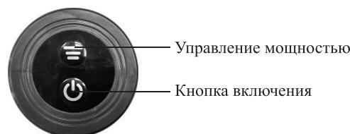
**Кнопка «Вкл/Выкл»** включает или отключает пылесос.
