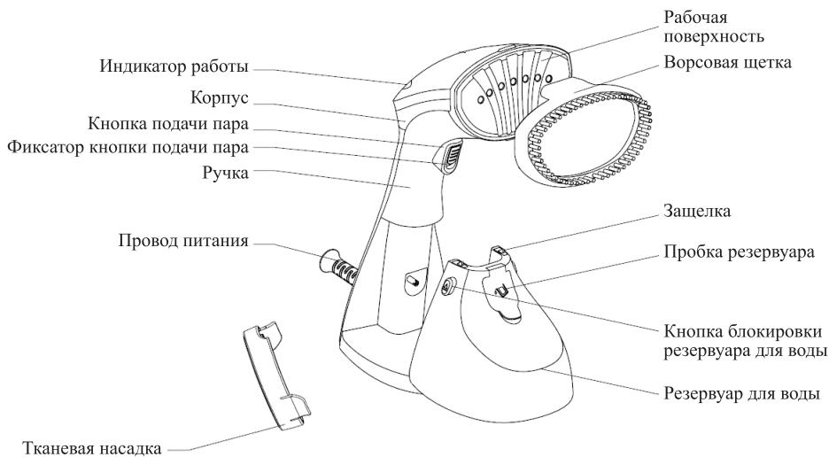
Резервуар для воды у отпаривателя съемный. Вода из резервуара подается в бойлер помпой (водяным насосом), где испаряется; пар выходит через паровые сопла на рабочей поверхности. Использование помпы позволяет точно дозировать количество подаваемой в бойлер воды и получать устойчивую подачу пара. После включения отпаривателя в розетку, индикатор работы начнет мигать, информируя о нагреве. После того, как прибор нагреется, индикатор работы перестанет мигать, информируя о готовности к работе.
