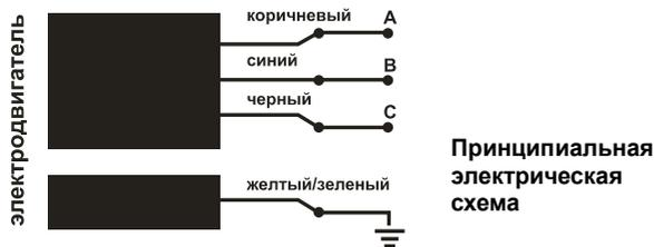
Принципиальная электрическая схема
