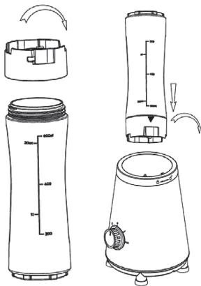
Скрутите крышку с бутылки. Положите ингредиенты внутрь. Накрутите на бутылку блок лезвий. Для чаши и бутылок используется один и тот же блок лезвий для блендера.
