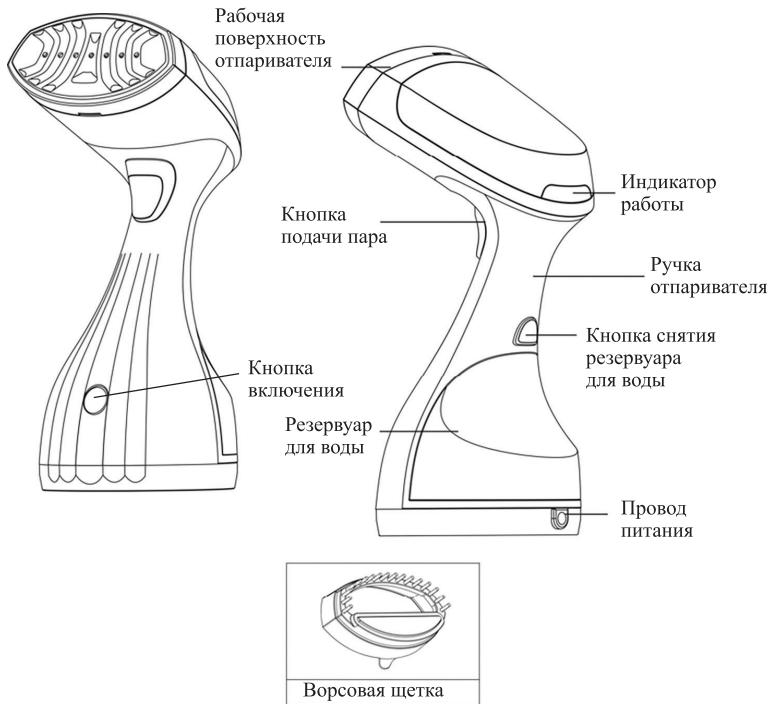
Отпариватель КТ-954 оснащен помпой (водяным насосом). Помпа подает воду из резервуара для воды в бойлер, где она испаряется. Это позволяет получать пар под давлением выше атмосферного.
