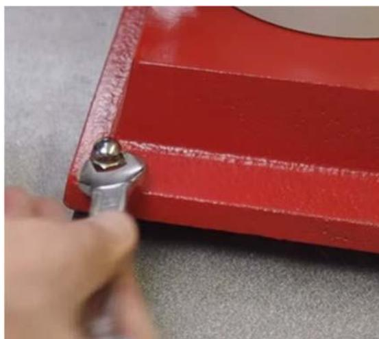
Рис. 5.2.Закрутите с помощью рожкового ключа
