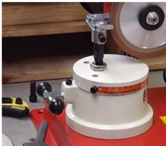
Рис. 3.2. Открутите винты фиксирующие шестигранные
