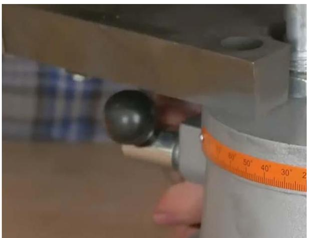
Рис. 16.2 Винт фиксации суппорта (3)
