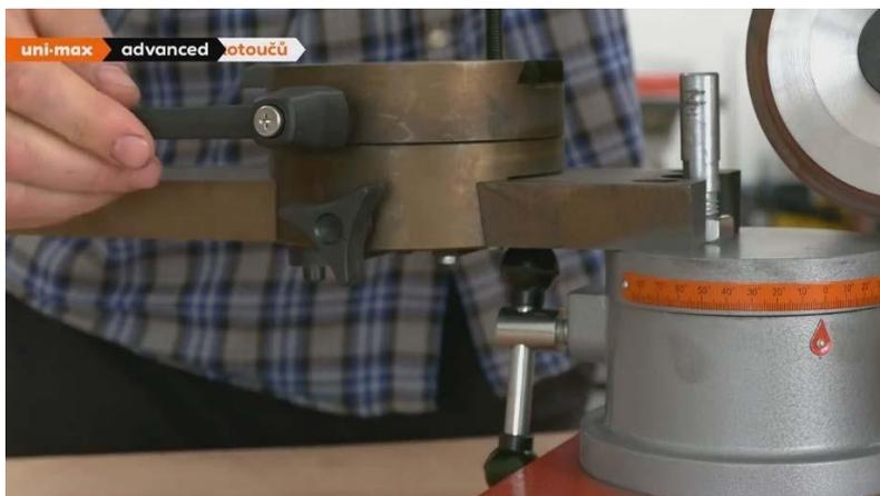
Рис. 12.3 Ослабьте винт (6) Винт суппорта
