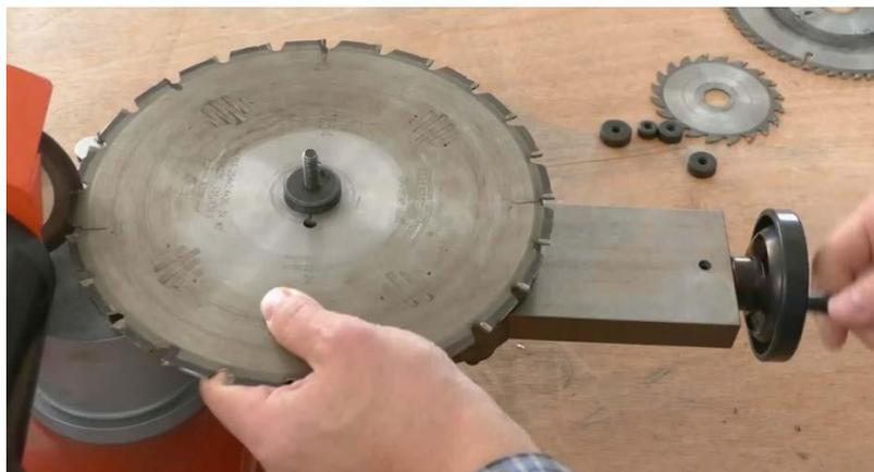
Рис. 13.1 Маховиком (8), установите диск в рабочее положение
