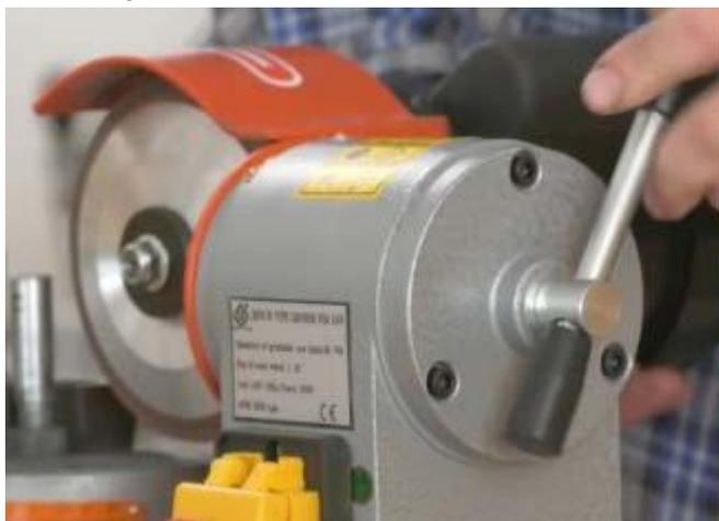
Рис. 11.1 Ослабьте крепеж винта (18)
