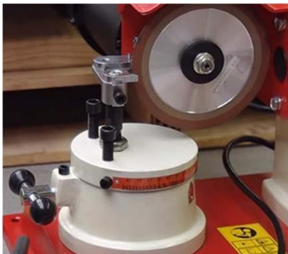
Рис. 3.1. Винты фиксации опоре суппорта
