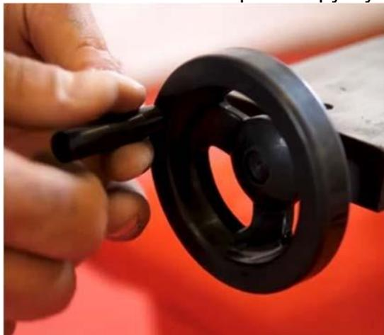
Рис. 4.3. Установите и закрутите ручку в маховик
