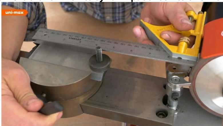
Рис. 14.1 Установите ползунок параллельно плоскости шлифовального круга
