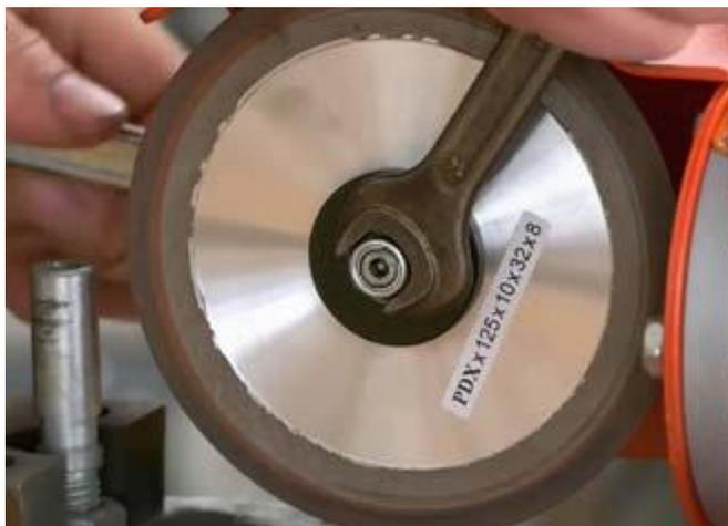
Рис. 8.1 Снять зажимную гайку
