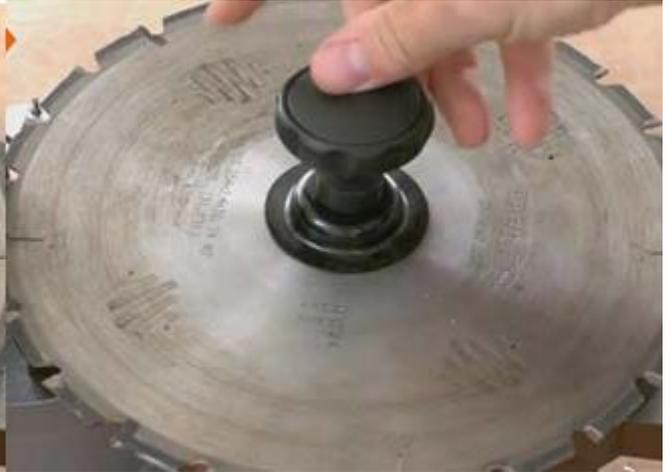
Рис. 15.4 Зафиксируйте пильный диск ручкой винтом (12)
