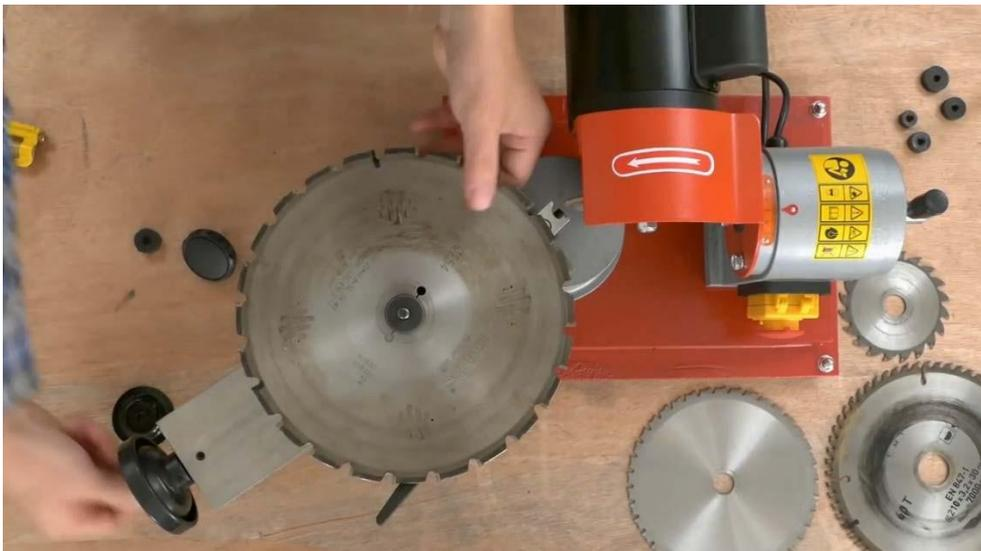
Рис 21.2 Маховиком (8), установите диск в рабочее положение. Зафиксируйте положение винтом (5)
