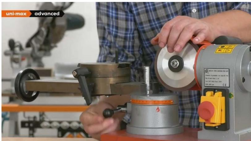
Рис. 12.1 Ослабьте винт (3) Винт фиксации стойки суппорта
