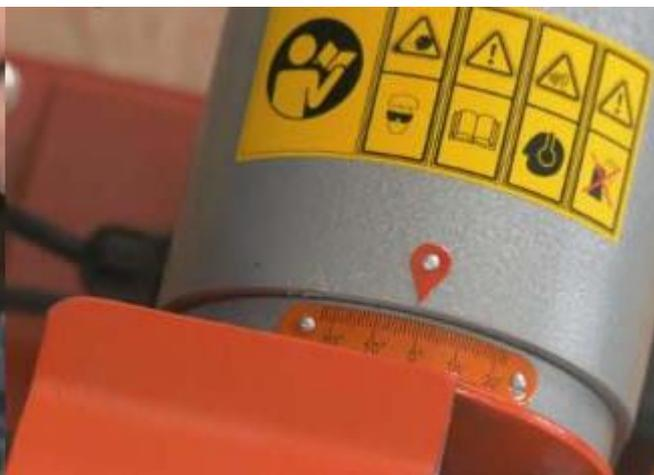
Рис. 11.2 Установите угол наклона 0 град
