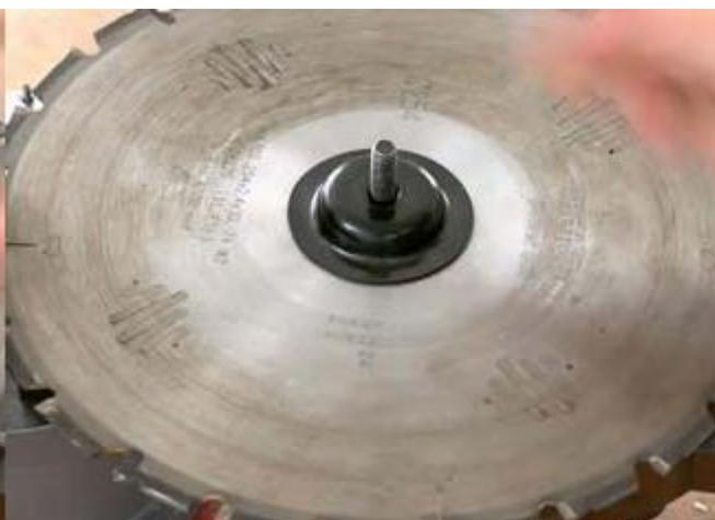
Рис. 15.2 Установите прижимную пластину (11)
