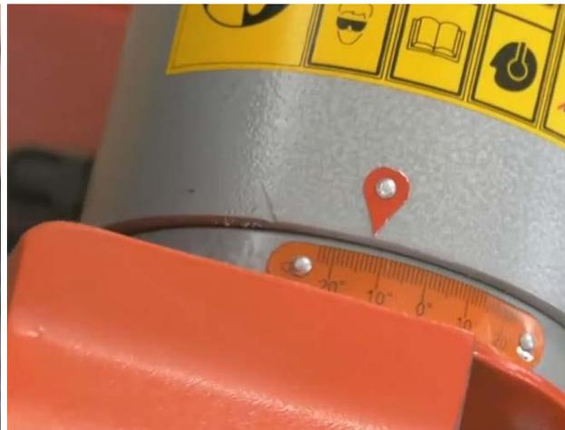
Рис. 20.2 Установите угол наклона
