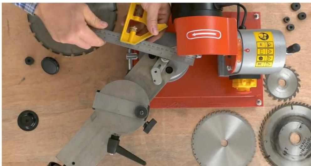
Рис 22 4 Ползун должен быть параллелен конусной стороне диска. Зафиксируете данное положение винтом ползуна (6)
