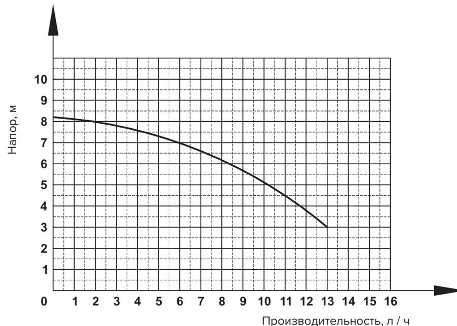
Рисунок 1 — График зависимости производительности насоса от напора
