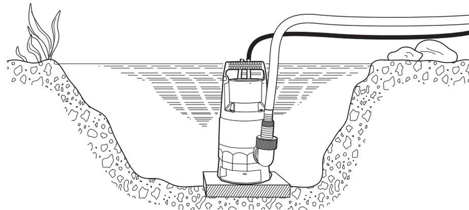
Рисунок 4 — Пример установки насоса на дне водоема
