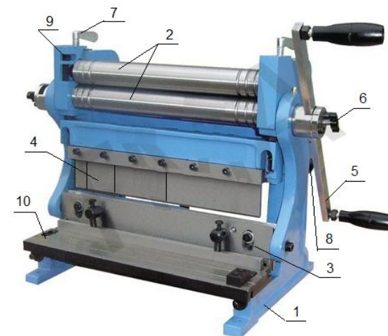
1-станина; 2-вальцы; 3-универсальный гильотинный нож с прижимом; 4-сегментная гибочная балка; 5-рукоятка привода; 6-фиксатор рукоятки привода; 7- регулятор верхнего вальца; 8-регулятор нижнего вальца; 9-фиксатор верхнего вальца; 10-стол для резки.
