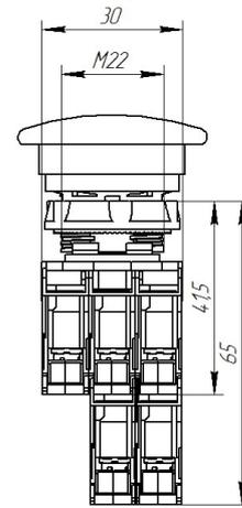
**Рис.3. Выключатель кнопочный с**
