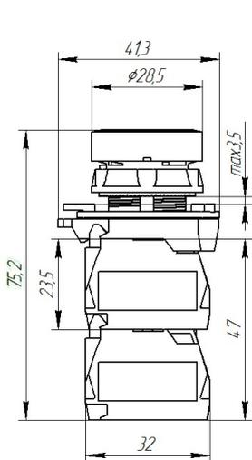
**Рис.2. Выключатель кнопочный**
