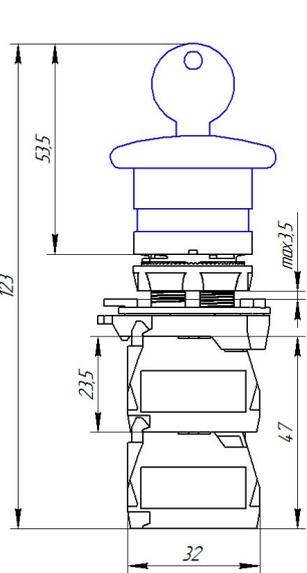
**Рис.5. Выключатель кнопочный с**
