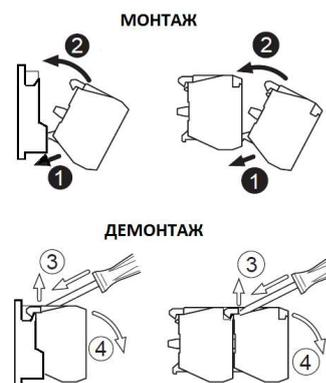
Рис.14 Монтаж и демонтаж блоков контактов и основания.
