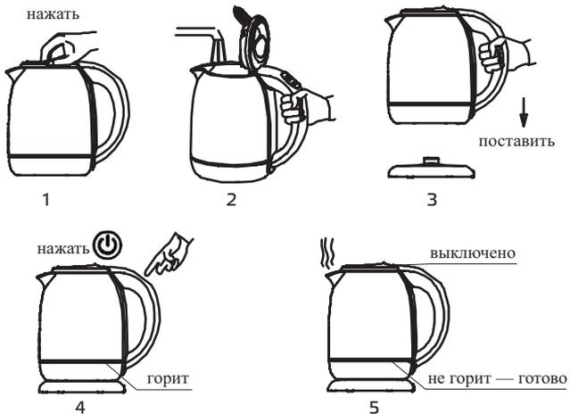
**Кипячение воды.** Нажмите кнопку «Старт/Стоп». Загорится индикатор на чайнике и начнется нагрев воды. На дисплее отображается текущая температура воды. После закипания воды чайник подаст звуковой сигнал и автоматически отключится.
