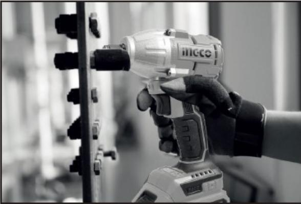
Крепко держите инструмент и поместите ударное гнездо на болт или гайку. Включите инструмент и закрепите его в течение надлежащего времени затяжки.
