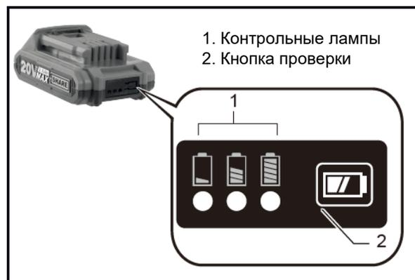
Нажмите кнопку проверки на батарее, чтобы отобразить оставшуюся емкость батареи. Индикатор загорается на несколько секунд.
