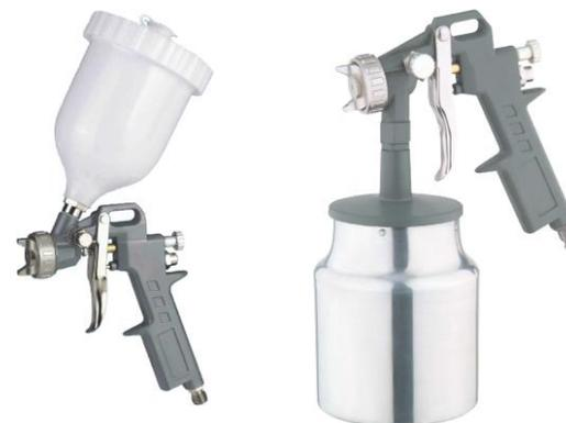
При нажатии на спусковой рычаг открывается воздушный клапан, при дальнейшем нажатии дозирующая игла освобождает запорное сопло, вещество для распыления вытекает из насадки сопла и одновременно распыляется поступающей струей воздуха.
