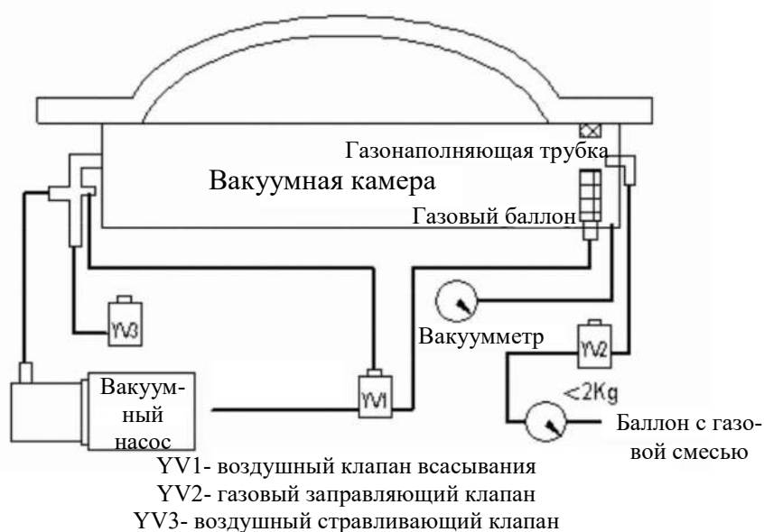
Схема вакуумного упаковщика с системой газации
