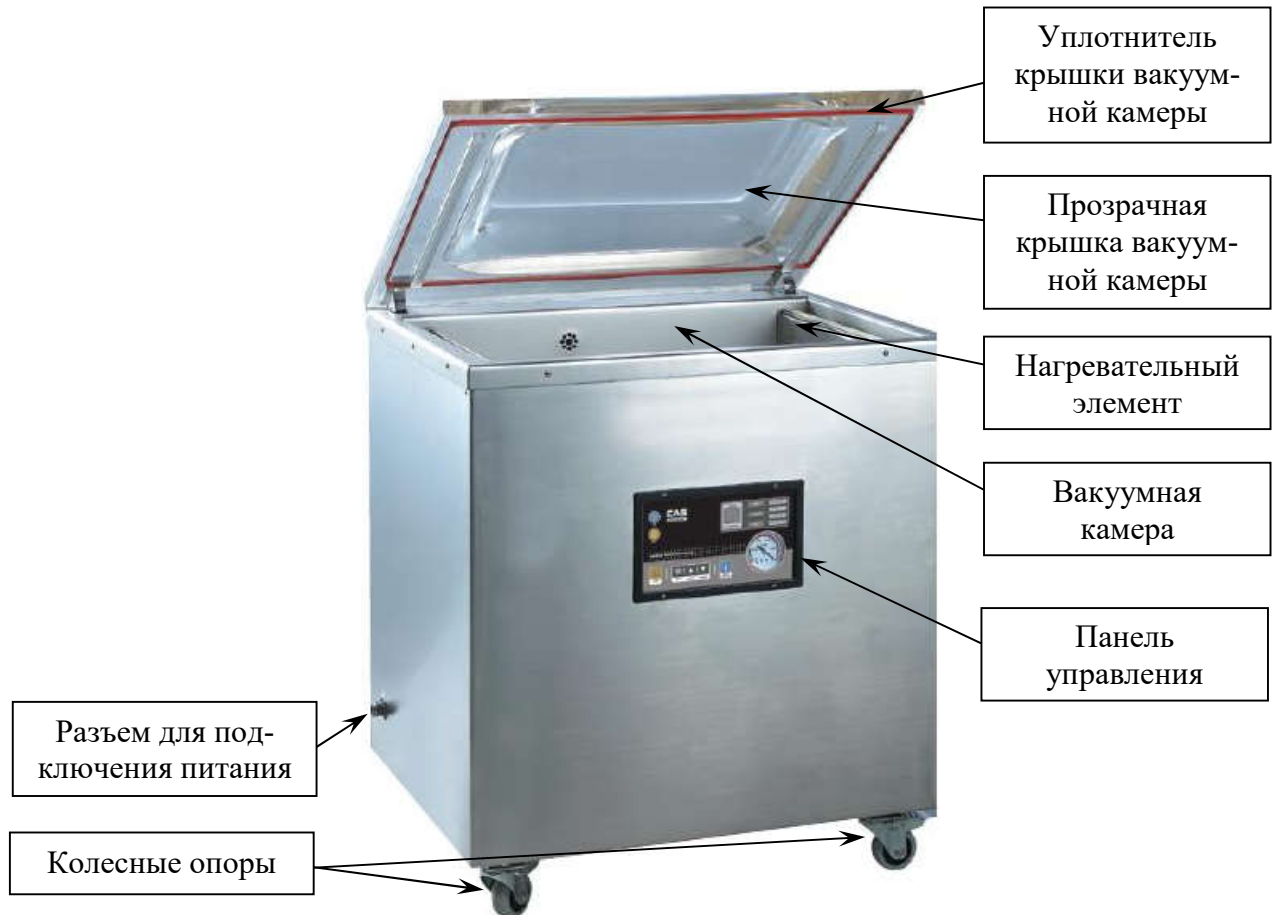
Рисунок 4.1 - Общий вид и обозначение основных элементов
