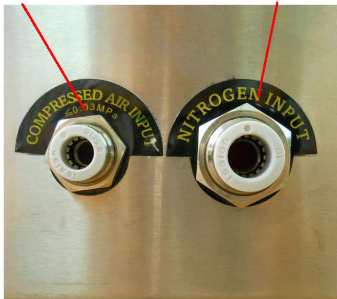
Рисунок 4.2 – Расположение разъемов на задней стенке вакуумного упаковщика
