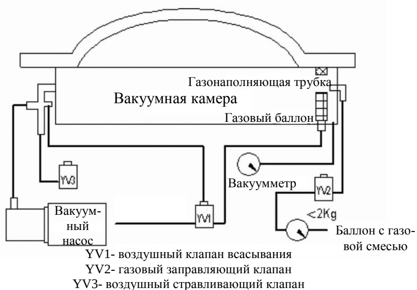
Схема вакуумного упаковщика с системой газации
