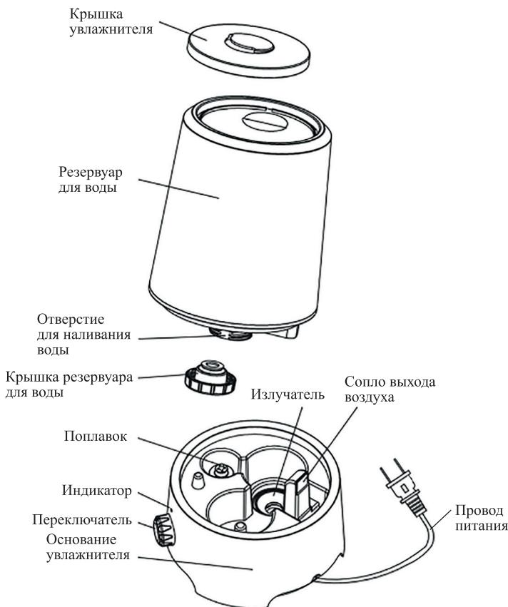
Включается увлажнитель при помощи переключателя, при повороте по часовой стрелке раздастся щелчок — значит, увлажнитель включен, при этом над переключателем загорится индикатор. Поворачивая переключатель по часовой стрелке, регулируйте нужный вам поток тумана.
