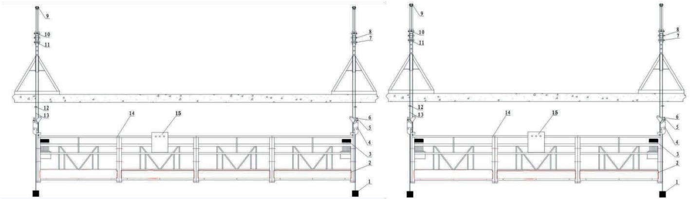
**Рисунок 1: Фасад подвесной рабочей платформы**
