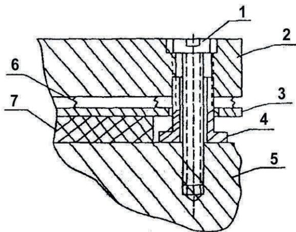
**Рисунок 12 – Электромагнитный тормоз**
