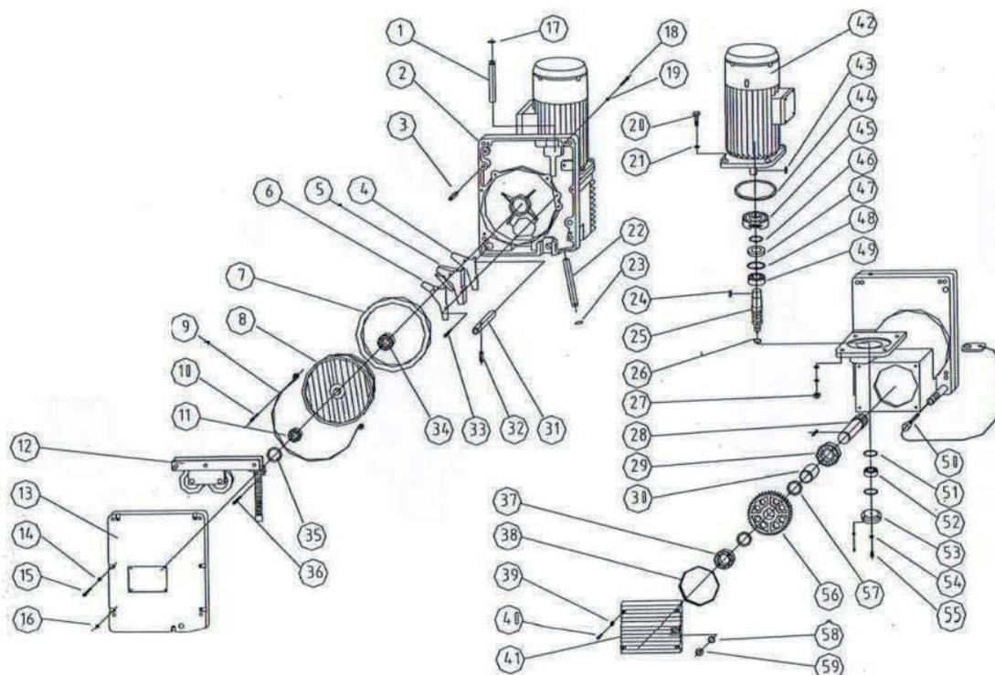
Рисунок 5 – Расположение деталей лебёдки LTD630
