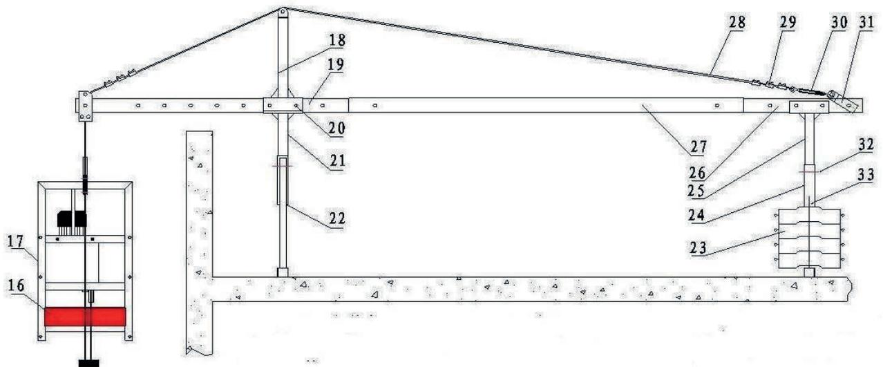
**Рисунок 2: Профиль электрической рабочей платформы**
