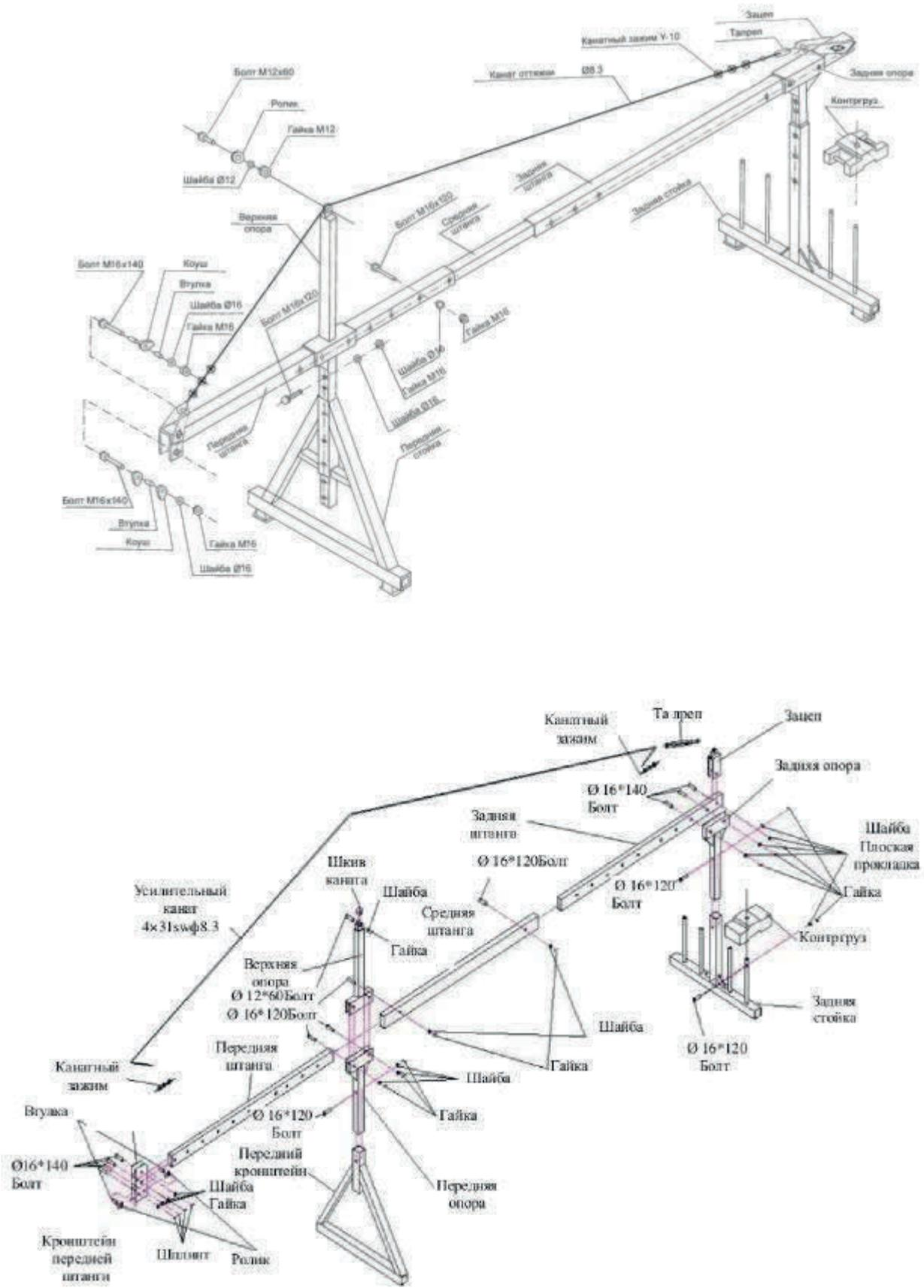
Рисунок 8 – Сборка консоли фасадного подъемника
