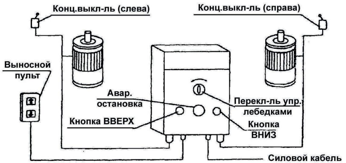
Рисунок 10 – Пульт управления подъемником
