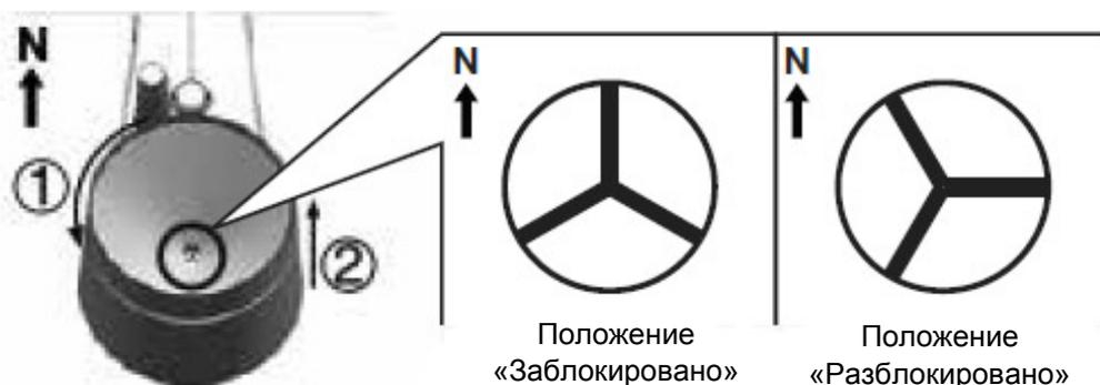
1. Поверните дождемер на 30° против часовой стрелки.
