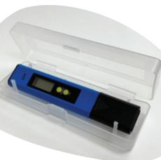
5) **Солеметр** – предназначен для измерения уровня растворенных веществ в воде. С его помощью Вы сможете определять когда растение поглотило значительную часть питательных веществ и требуется добавление концентрата питательного раствора (менее 1000ррт).
