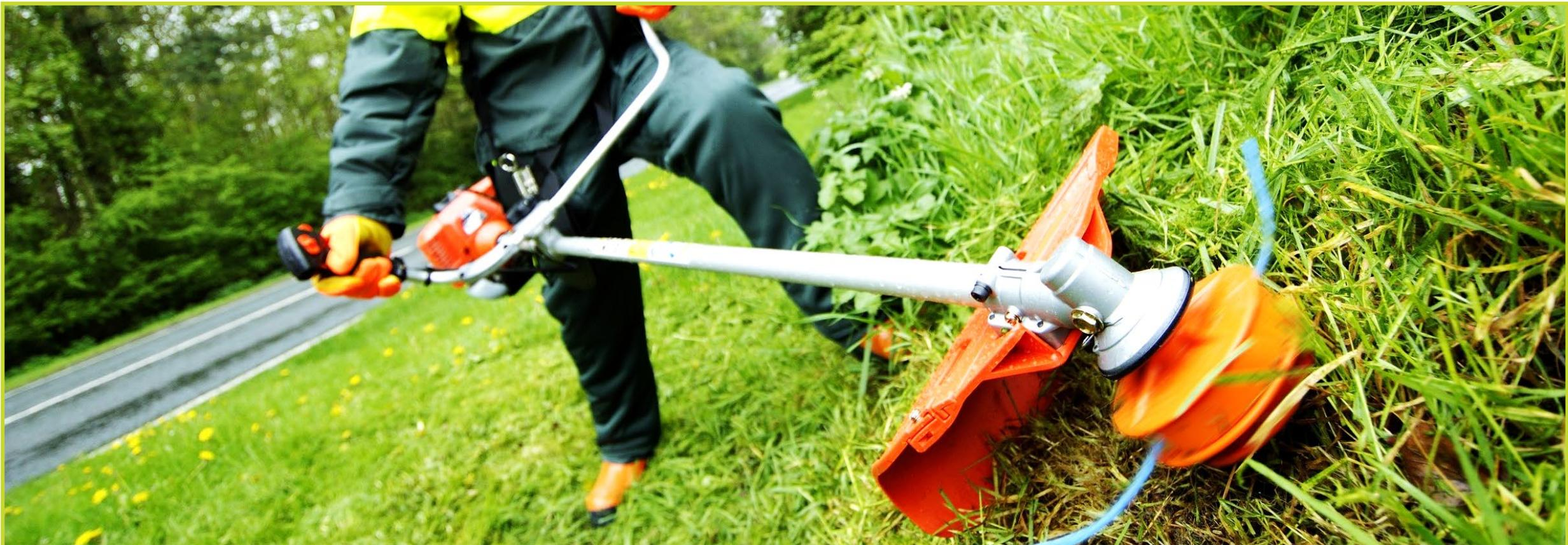
**ТРИММЕР** – это легкий и компактный инструмент, которым можно скосить небольшие участки газона, траву у деревьев, забора и в других неудобных местах. Триммером можно косить как мягкую и ухоженную газонную траву, так и поросль, сухостой и высокие грубые сорняки. Главное – правильно выбрать леску или диск для триммера.
