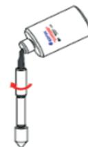
4. Ввернуть Головку удароприемную в Муфту соединительную. В перфоратор (электромолот) вставить Насадку для перфоратора SDS-max.
