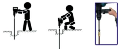
6. Вывернуть Головку удароприемную. Довернуть Муфту соединительную (допускается использование ключа трубного).
