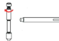
5. Заглубить первый Стержень заземления. Во избежании разрыва муфты, через каждые 30 см заглубления необходимо ее подкручивать, поскольку при вибрации муфта раскручивается.
