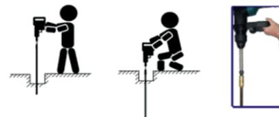
6. Вывернуть Головку удароприемную. Довернуть Муфту соединительную (допускается использование ключа трубного).
