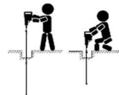
9. В случае невозможности достичь требуемого сопротивления растеканию тока одним очагом, допускается забивать необходимое количество очагов с последующим их объединением. Объединение очагов и присоединение проводника производится при помощи Зажима заземления. После закрепления Зажима заземления необходимо изолировать (обмотать) его Лентой изолирующей.
