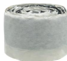
Изготовлена из нетканого синтетического волокнистого материала, пропитанного и покрытого нейтральным составом на основе насыщенного нефтяного углеводорода (петролатум) и инертного кремнийсодержащего наполнителя. Остается пластичной под воздействием широкого спектра температур. Не затвердевает и не растрескивается. Высокостойкая к неорганическим кислотам, щелочам, солям и микроорганизмам, высокогерметичная в отношении воды, водяного пара и газа.
