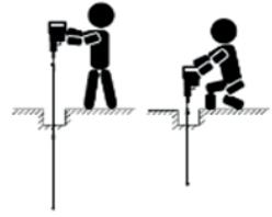
9. В случае невозможности достичь требуемого сопротивления растеканию тока одним очагом, допускается забивать необходимое количество очагов с последующим их объединением. Объединение очагов и присоединение проводника производится при помощи Зажима заземления. После закрепления Зажима заземления необходимо изолировать (обмотать) его Лентой изолирующей.
