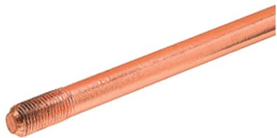
Высококачественная сталь в таком заземлителе выполняет кроме электропроводящей еще и необходимую для заглубления электрода в почву - механическую роль. Штыри обладают высоким пределом прочности на разрыв 600 Н/мм<sup>2</sup> и могут быть погружены в грунт при помощи отбойного молотка на большую глубину (до 40 метров).
