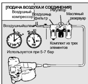
**ФИТИНГИ:** Подсоедините к инструменту штепсельный разъем свободного течения, который будет отключать подачу воздуха на инструмент при отсоединении от компрессора.
