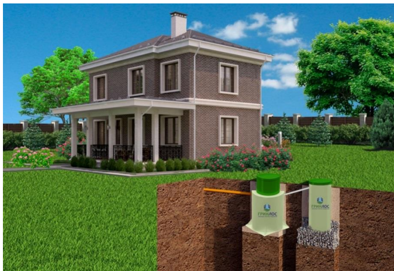
Рисунок 19. Монтаж с принудительным забором воды в фильтрующий колодец (Модели со стандартной высотой корпуса)
