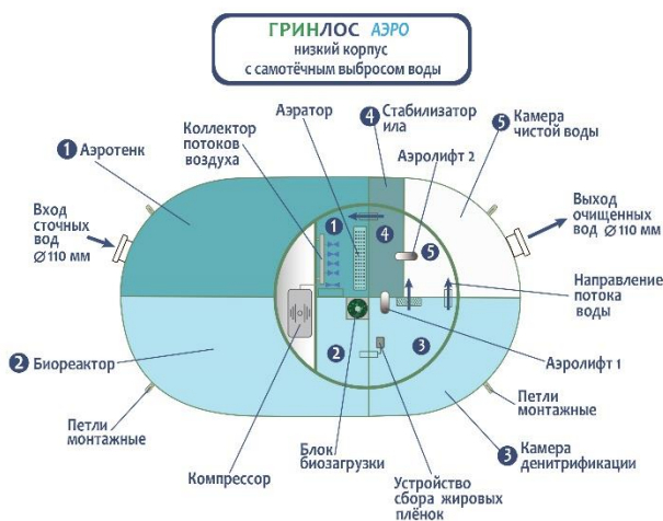
Рисунок 7. Технология очистки стоков в моделях с низким корпусом
