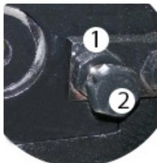
б) Если кабели/проводка не были разделены должным образом (разрезы слишком мелкие или слишком глубокие) отрегулируйте устройство с помощью регулятора (1) и (2) на рисунке ниже:
