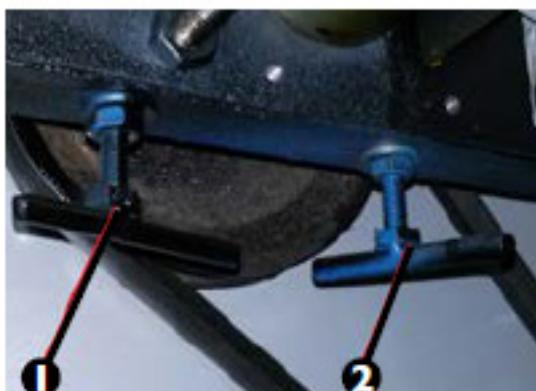
Эти регуляторы находятся под нижним валом, над двигателем. Затягивание приведёт к увеличению зазора между нижним и верхним валами (к более мелкому прорезанию), откручивание приведёт к уменьшению зазора между нижним и верхним валами (к более глубокому прорезанию).
