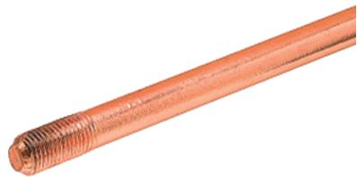
Высококачественная сталь в таком заземлителе выполняет кроме электропроводящей еще и необходимую для зарывания электродов в почву - механическую роль. Штыри обладают высоким пределом прочности на разрыв 600 Н/мм<sup>2</sup> и могут быть погружены в грунт при помощи отбойного молотка на большую глубину (до 40 метров).
