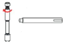
5. Заглубить первый Стержень заземления. Во избежании разрыва муфты, через каждые 30 см заглубления необходимо ее подкручивать, поскольку при вибрации муфта раскручивается.
