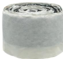
Изготовлена из нетканого синтетического волокнистого материала, пропитанного и покрытого нейтральным составом на основе насыщенного нефтяного углеводорода (петролатум) и инертного кремнийсодержащего наполнителя. Остается пластичной под воздействием широкого спектра температур. Не затвердевает и не растрескивается. Высокостойкая к неорганическим кислотам, щелочам, солям и микроорганизмам, высокогерметичная в отношении воды, водяного пара и газа.
