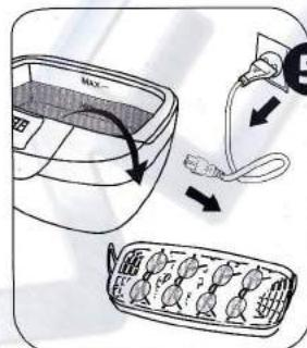
Если работа закончена, выдерните электрическую вилку из розетки и откройте крышку прибора. Вылейте воду из контейнера и протрите его изнутри.
