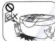
Не подключайте ванну, не залив чистящую жидкость. Уровень жидкости не должен превышать, указанную в резервуаре максимальную отметку, а также не должен быть менее половины ёмкости.
