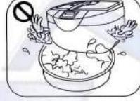
Не кладите и не роняйте прибор в воду или другие жидкости, чтобы избежать замыкания.
