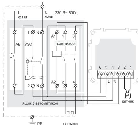
Схема 2. Подключение через магнитный пускатель
