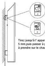
Retirez le radiateur du mur
