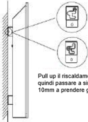
Smonta la stufa dal muro
