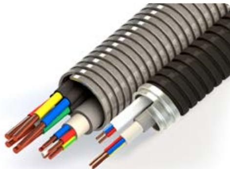
Не смотря на большой ассортимент металлорукава, каждый тип соответствует конкретному применению. Так, металлорукав «Маслобензостойкий, морозостойкий» активно применяется в нефтяной и газовой промышленности, а «Морозостойкий» применим в промышленных холодильных камерах. Металлорукав РЗ из нержавеющей стали положительно переносит повышенную влажность и подходит для тропического климата.
