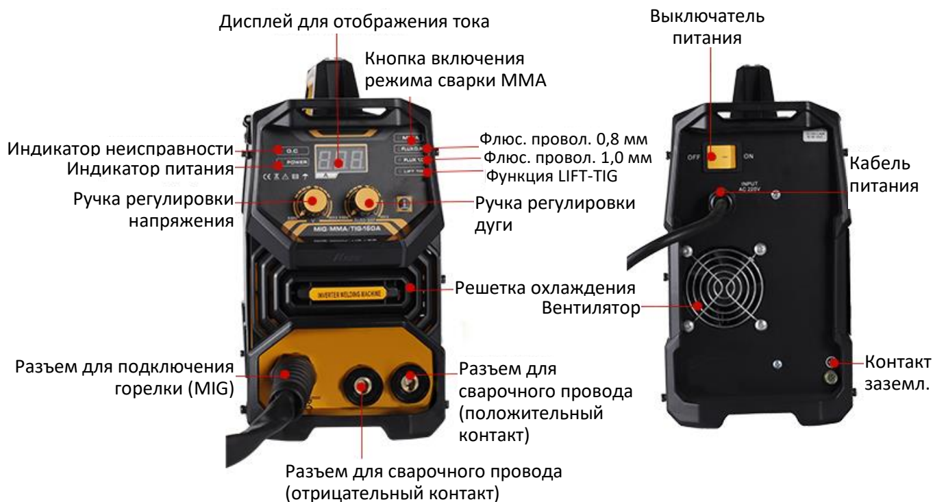
Рис. 1. Инверторный сварочный аппарат MIG-160A. Основные элементы.
