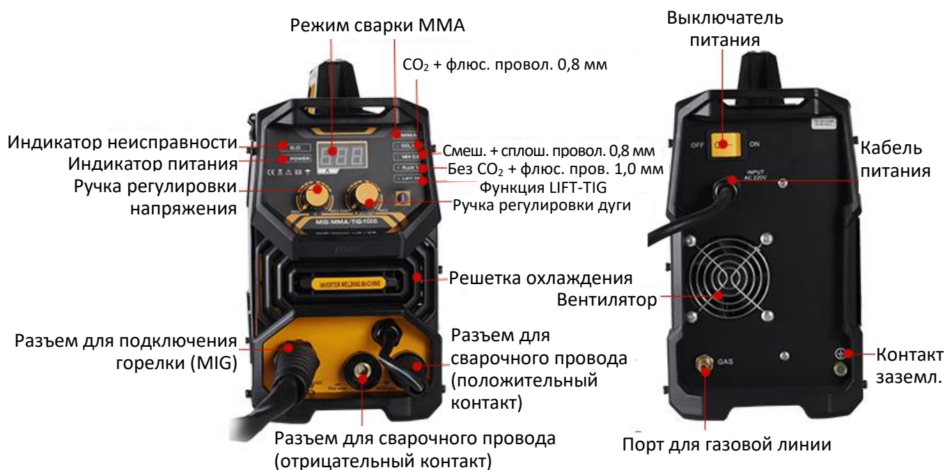
Рис. 2. Инверторный сварочный аппарат MIG-160B. Основные элементы.
