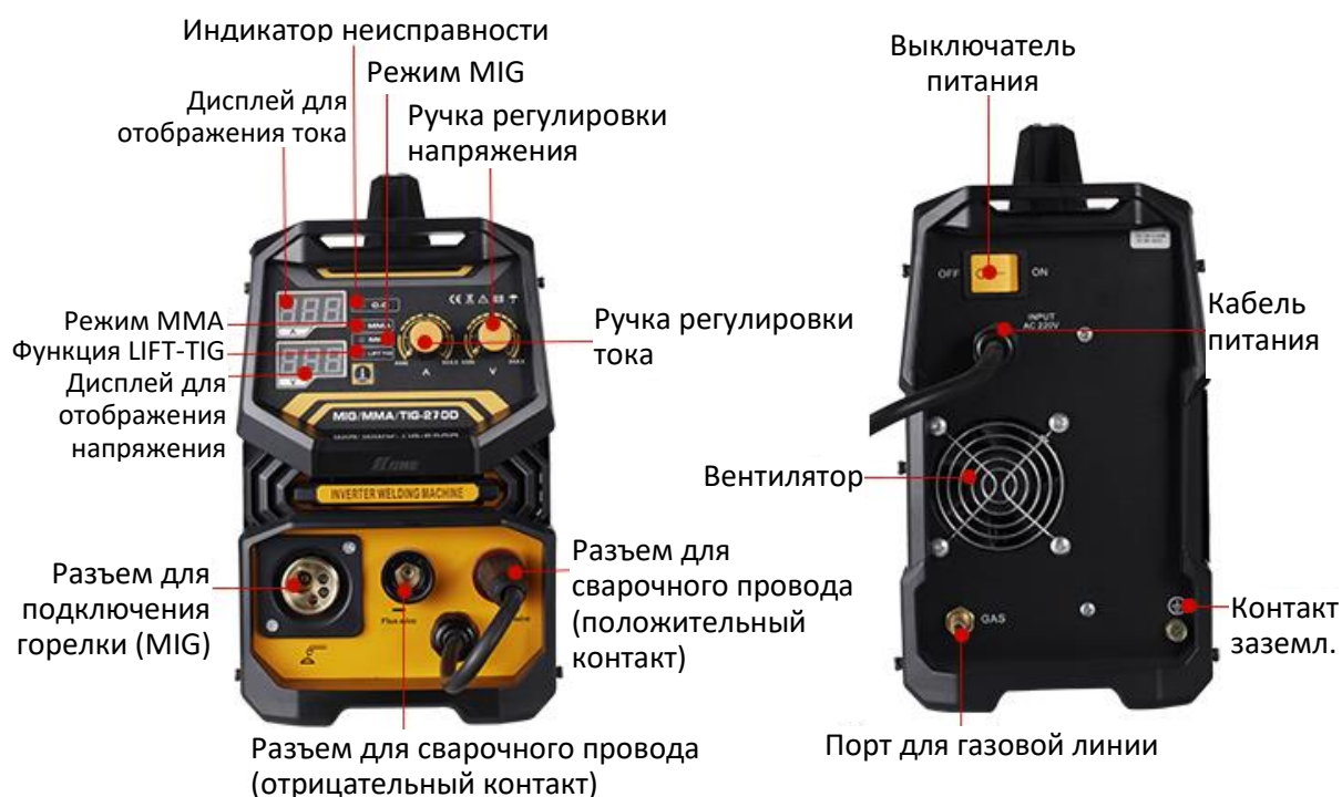
Рис. 3. Инверторный сварочный аппарат MIG-200D. Основные элементы.
