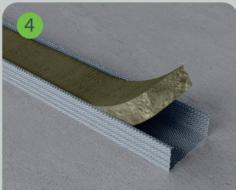
Потолочные профили SoundGuard Strong ПП 60/27 заполняются звукопоглощающим материалом SoundGuard ЭкоАкустик 30.
