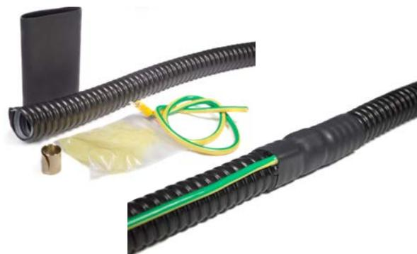
В случаях использования металлорукава в ПВХ-изоляции и невозможностью установить заземляющее устройство на вводную муфту ВМ или ВМУ, для сохранения степени защиты IP необходимо использовать термоусаживаемую муфту заземления Промрукав.
