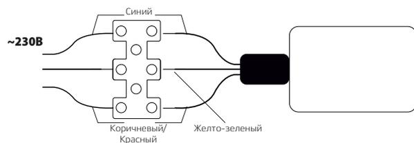
Подсоедините питающие (одноцветные) провода к клеммной колодке. Если светильник устанавливается на металлической поверхности, поверхность должна быть заземлена.
