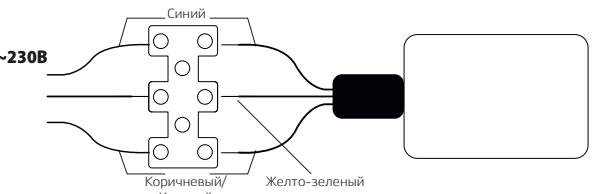
**Схема подключения светильника к сети переменного тока 230 В**
