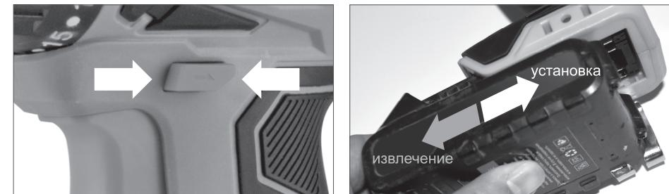
Установите переключатель направления вращения в среднее положение (блокировка), установите аккумулятор в дрель согласно направляющим. После характерного щелчка переведите переключатель направления вращения в любую крайнюю позицию и нажмите кнопку выключателя. Если все в порядке – патрон начнет вращаться.
