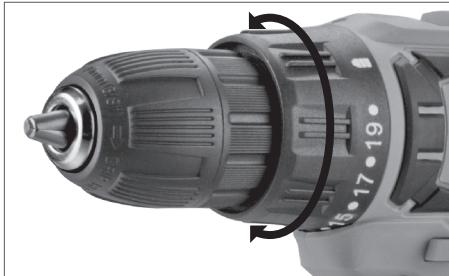
Аккумуляторные дрели «Elti» оснащены многоступенчатым регулятором усилия крутящего момента. Кольцо с цифрами позади патрона разбито на 21 позицию (20 + сверление). В положении «сверление» усилие ничем не ограничивается, в остальных же позициях устанавливается ограничение на усилие. Это удобно использовать, к примеру, при завинчивании шурупов и винтов. Без
