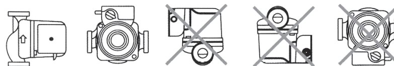
Положение насоса при монтаже
