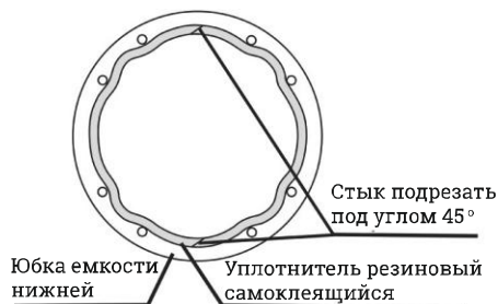
Схема установки резинового уплотнителя
