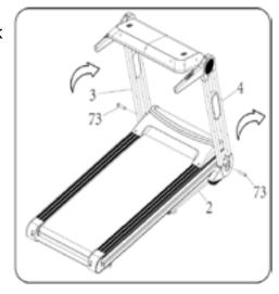
**Стадия 3.** Удерживая поручни (8, 9) в положении кан показано на рисунке, закрепите их на стойках (3, 4) болтами (82). Возьмитесь двумя руками за монитор (5) и медленно с небольшим усилием поверните его до упора в сторону как показано на рисунке.
