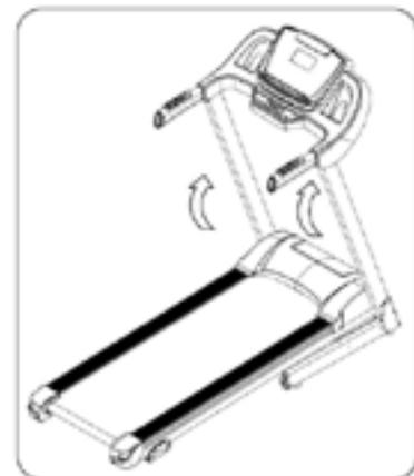
**Стадия 4.** С помощью шестигранника на 5 мм зафиксируйте сначала левую стойку (3) болтом M8\*45 (53) и шайбой (73), затем, болтом M8\*16 (51) и шайбой (64). Повторите то же самое с правой стойкой.
