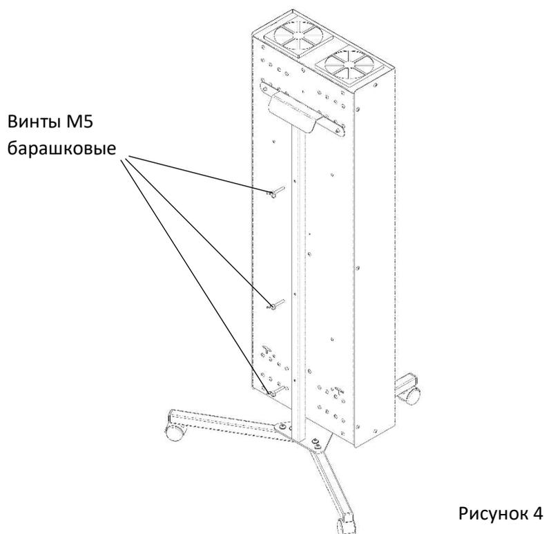
г) зафиксировать рециркулятор на вертикальной штанге стойки при помощи барашковых винтов (рисунок 4).
