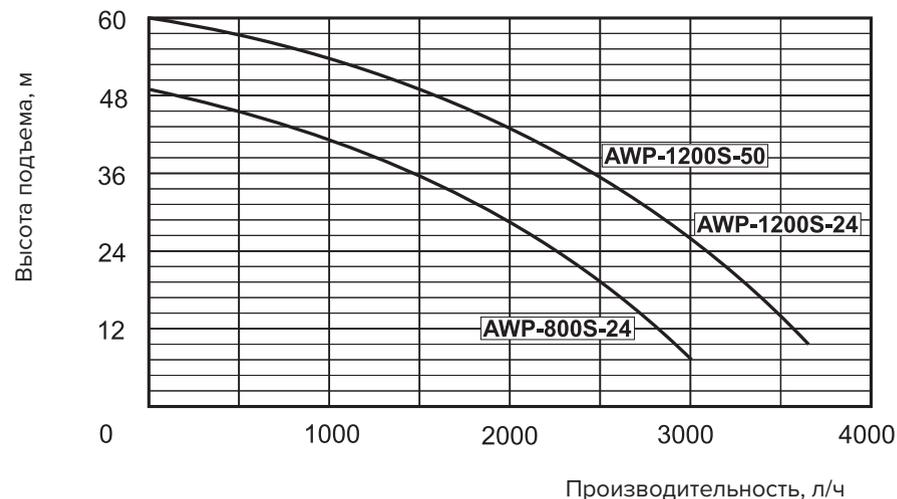
**Рисунок 1** — График зависимости производительности насосной станции от высоты подъема воды
