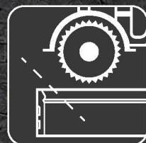
При углах не равных 90 градусов, использовать торцовочную пилу. Пильный диск должен иметь максимальное число зубьев (диск для резки алюминия). Выставить необходимый угол и произвести запил.
